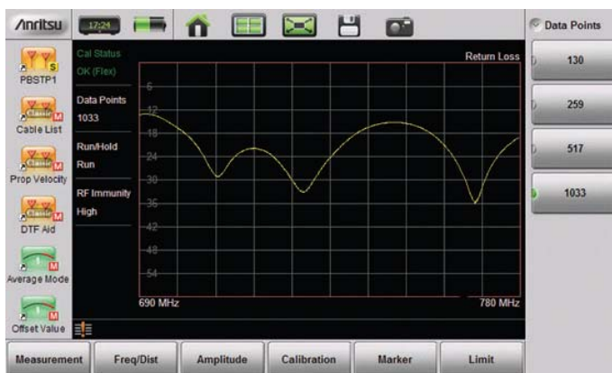
Увеличение количества точек данных до 1033 позволяет с легкостью расширить максимальный диапазон при измерении расстояния до повреждения
